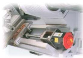
Servo-motores dos eixos X, Z
