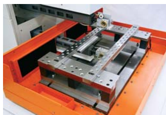
Eixos x,y,u e v controlados simultaneamente
