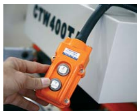
Botoeira portátil para aproximação rápida do fio
