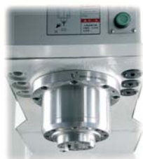
Eixo-árvore com rotação de 8.000 rpm Cone BT-40
