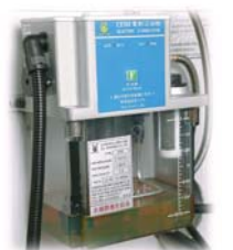
Sistema de lubrificação automática programável
