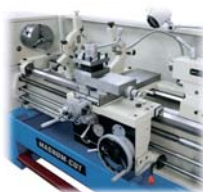
Carro transversal, refrigeração e iluminação
