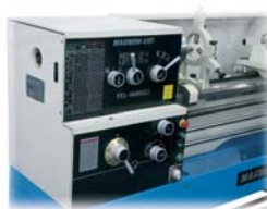
Painel de comando
