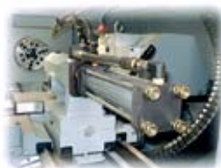
Torre e contra ponta hidráulicos
