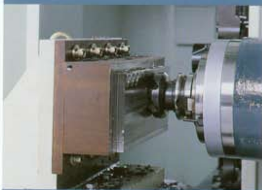
End mill \varnothing 40\text{mm}
