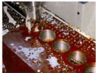
Rigid tapping max M45 x P3 (S45C)
