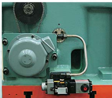
Ajuste motorizado da altura do martelo (60 ~ 250 tons).
