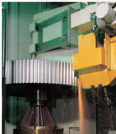
Engrenagem principal tratada e retificada
