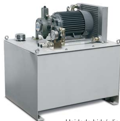
Unidade hidráulica para o movimento longitudinal
