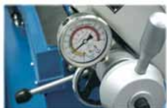
Tensionamento Hidráulico da fita (SBS-1018S e SBS-1335S)
