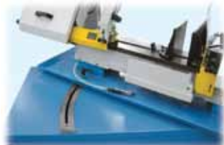
Corpo da Máquina Inclinável (SBS-1335S)
