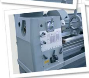
Caixa de distribuição
