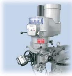
Sistema pneumático de troca rápida de ferramenta
