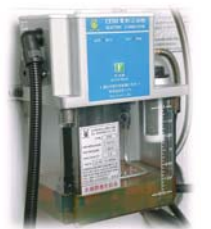
Sistema de lubrificação automática programável
