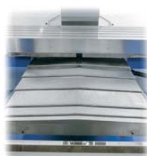
Proteções telescópicas para os eixos X, Y e Z
